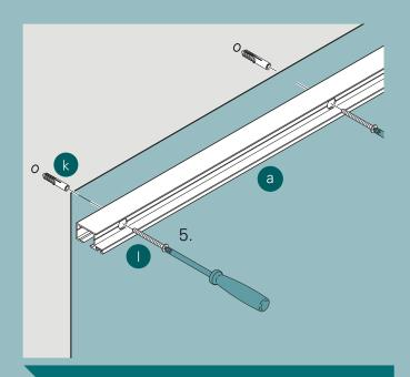
Das im Lieferumfang enthaltene Befestigungsmaterial ist nur für Mauerwerk und Porenbeton geeignet. Bei anderen Untergründen ist geeignetes Befestigungsmaterial bauseits zu stellen.
