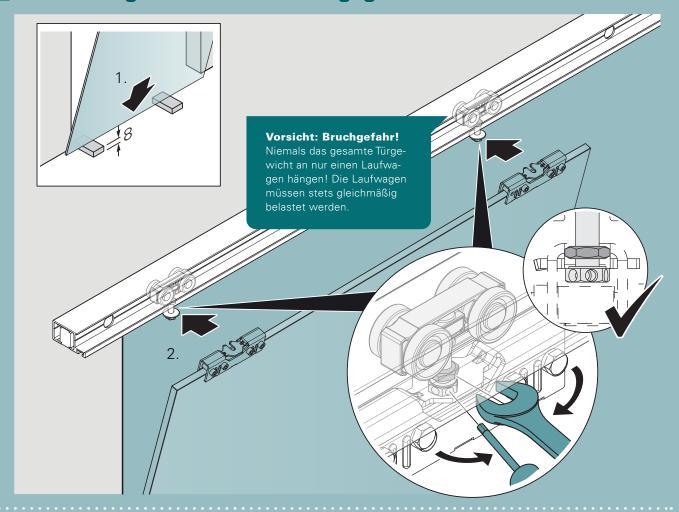
Bodenführung platzieren und Gleitbelag aufkleben.
